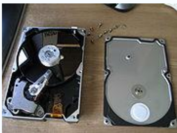
Разобранный жёсткий диск Quantum fireball (модель 2001 года )
