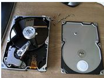
Разобранный жёсткий диск Quantum fireball (модель 2001 года )
