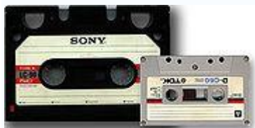
Сравнение размеров Elcaset и обычной кассеты
