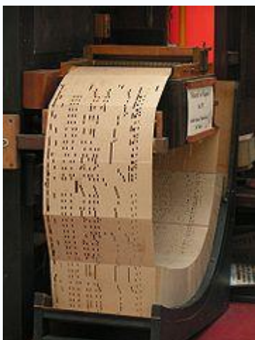
Перфокарточная система музыкального автомата
