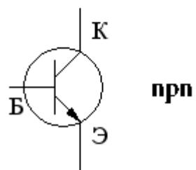
Обозначение биполярных транзисторов на схемах
