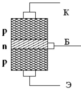
Простейшая наглядная схема устройства транзистора
