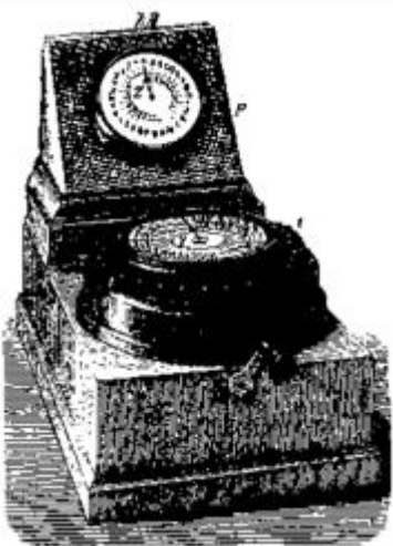
Указательный телеграф Уитстона
