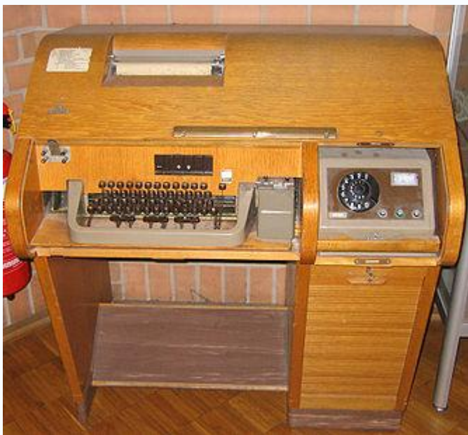
Телекс Siemens T100
