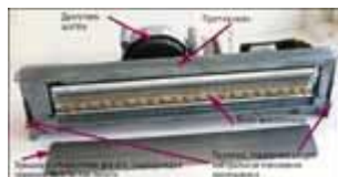
Рис.2. Блок молоточков (Hammer Bank) вместе со специальным противовесом, двигателем, шатуном, схемами управления током катушек, с подводщим к болку молоточков сигналы кабелем и другими элементами образует узел шатла (Shuttle - "челнок")
